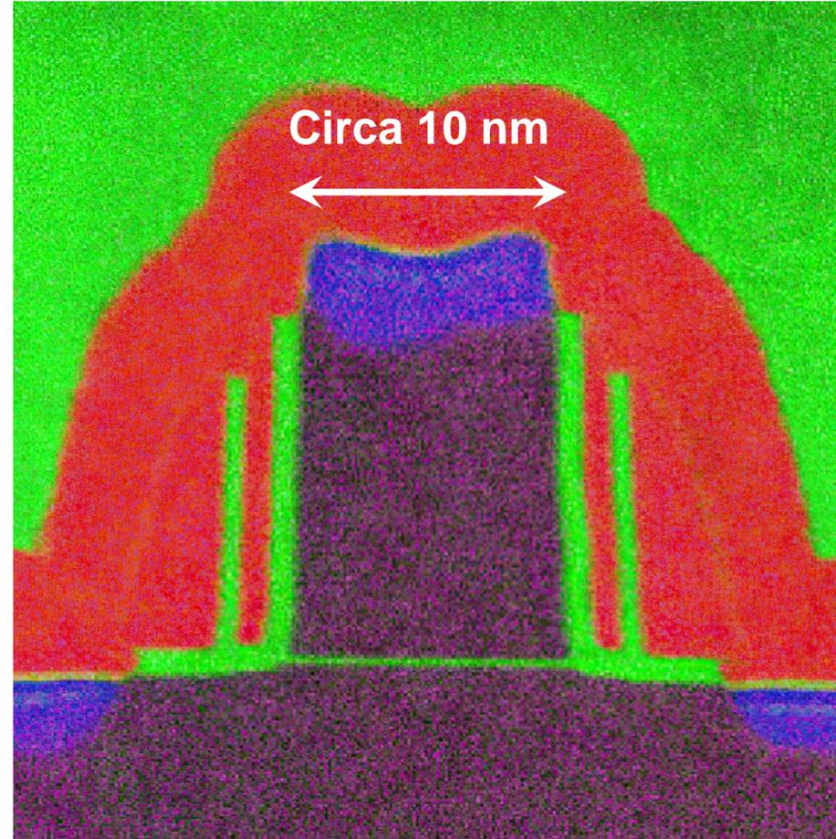
Sezione di un moderno **TRANSISTOR**
